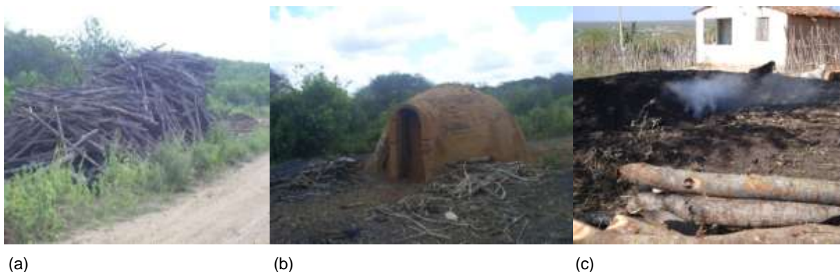
Figura 12: (a) Corte de lenha para uso doméstico e carvão; (b) forno de tijolo para carvão; (c) forno de “caieira” para carvão
