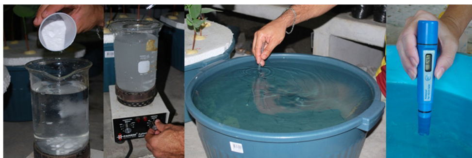
Figura 21 – Monitoramento da condutividade elétrica em experimentos com mudas de jatobá ( Hymenaea courbaril L.) submetidas à salinidade.
