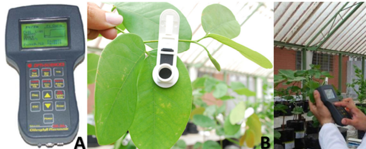
Figura 15 – Avaliação da eficiência quântica do fotossistema II em mudas de jatobá ( Hymenaea courbaril L.) utilizando-se um Fluorômetro. Em A , o equipamento utilizado; em B , pinças de adaptadas ao escuro e em C , realização das análises.
