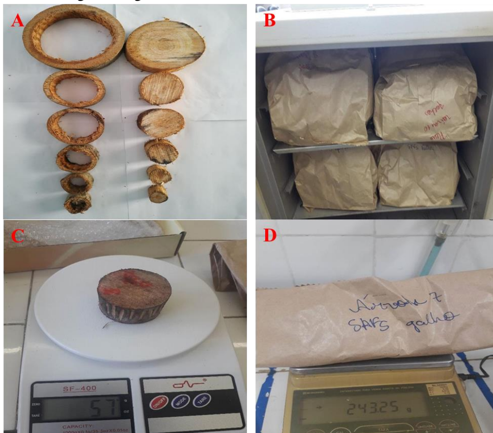
Figura 6 - Etapas do processo de pesagem e secagem do material de Khaya senegalensis (Desr.) A. Juss (discos, folhas e galhos) em laboratório. A – Separação da casca com alburno do material lenhoso; B – Alocação do material dentro da estufa; C – Pesagem dos discos de madeira; e D – Pesagem dos galhos dos indivíduos.
