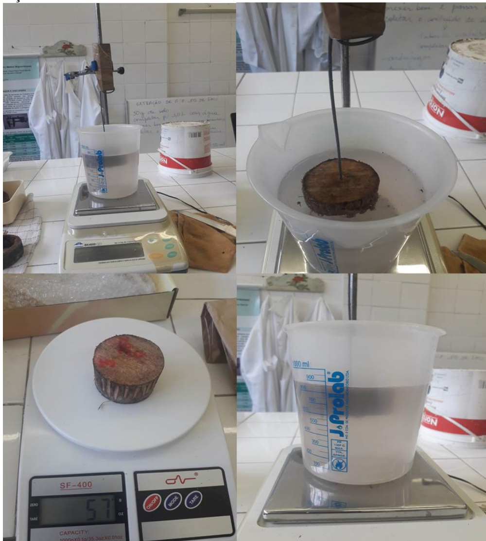
Figura 7 - Foto ilustrativa de dispositivo de imersão em água dos discos de madeira para determinação da densidade.
