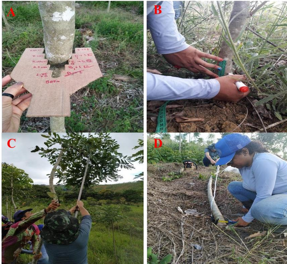
Figura 4 - Etapas do processo da cubagem rigorosa segundo o método de Smallian para a Khaya senegalensis (Desr.) A. Juss. A - Seleção da árvore pertencente às classes diamétricas estabelecidas; B – Demarcação do local do corte da árvore; C – Mensuração da altura dos indivíduos; e D – Mensuração do fuste nas diferentes secções.
